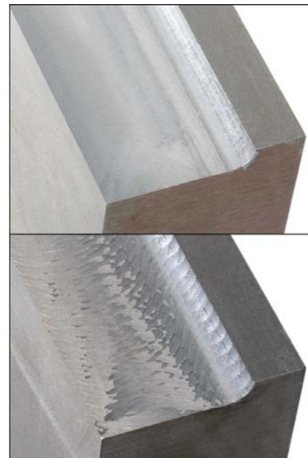
Oberes Bild: Frästeil mit ACC Unteres Bild Frästeil ohne ACC
