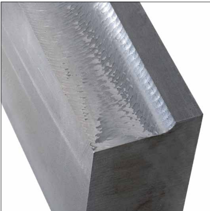
Деталь, обработанная без ACC: видны отчетливые следы ряби.
