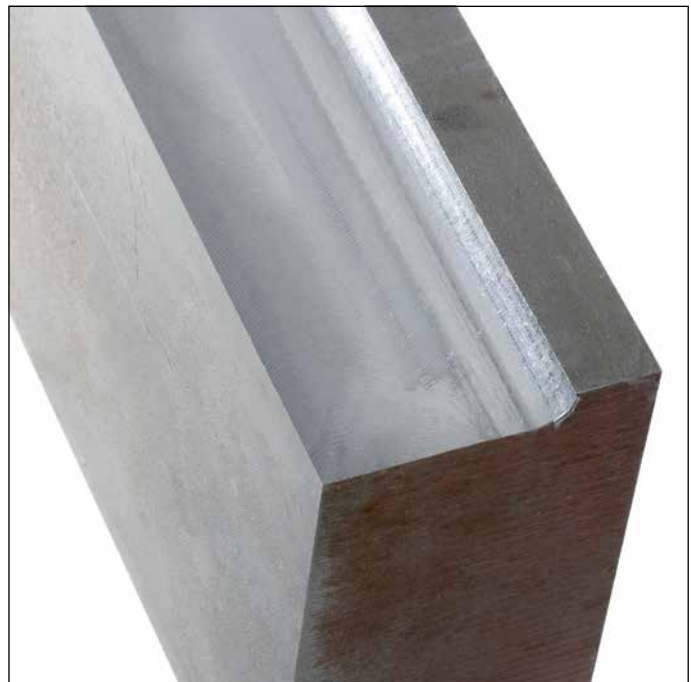
Деталь, обработанная с ACC: при одинаковой подаче и одинаковой глубине резания поверхность не имеет следов ряби. Уменьшение нагрузки на инструмент и станок.
